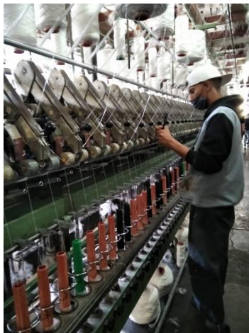
Figura 23. Limpieza de rodillos
